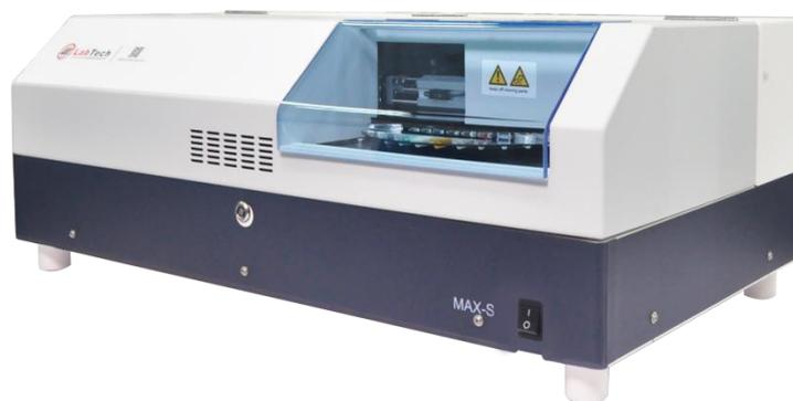
直接测汞仪使样品配制和样品分析一体化成为一个自动分析系统。自动进样由精密电气动系统完成，样品再自动插入石英分解管，该试管由两个单独的炉膛：干燥/分解炉和催化剂炉加热。在分解管内，样品首先经过干燥，然后再进行热分解。作为载气的氧气流将分解生成物通过分解管带入催化散炉中，并以最高 1000℃ 的温度完成分解，酸性卤化物和氧化物被吸附，残留的分解产物则进入纳米级金质汞齐化器，在此完成汞吸附。氧气流将一些残余气体排除。然后汞齐化器被迅速加热，汞蒸气被蒸发到吸收管，然后通过原子光谱法在 253.7nm 处进行测量，测出汞的绝对含量（ng）。
